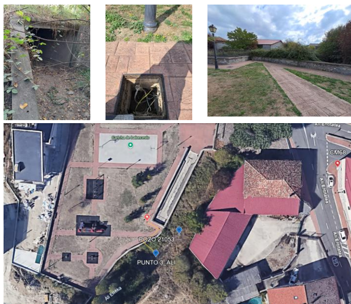
Figura 3 Vistas del punto de medición: acceso, interior del colector rectangular (2300x1500mm) y emplazamiento para armario con acometida eléctrica (aprox. 8m). Ubicación: PUNTO 3 - RÍO ALÍ.
