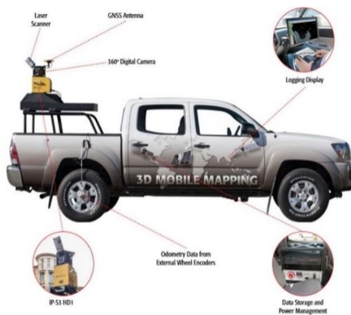
Esquema de los componente que integran el vehículo de levantamiento mediante mobile mapping
