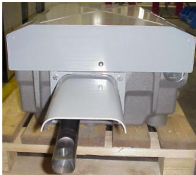
Fotografía 1: Vista del accionamiento electrohidráulico.
