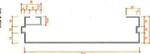
PERFIL DE ALUMINIO EXTRUSIONADO ESCALA 1:10 (cotas en mm)
