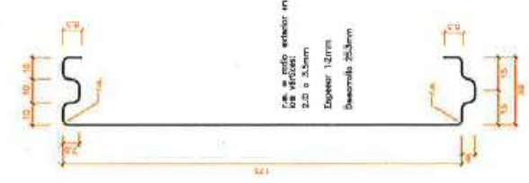
SECCIÓN TRANSVERSAL DE LA LAMA DE CHAPA DE ACERO GALVANIZADA ESCALA 1:10 (cotar en mm)
