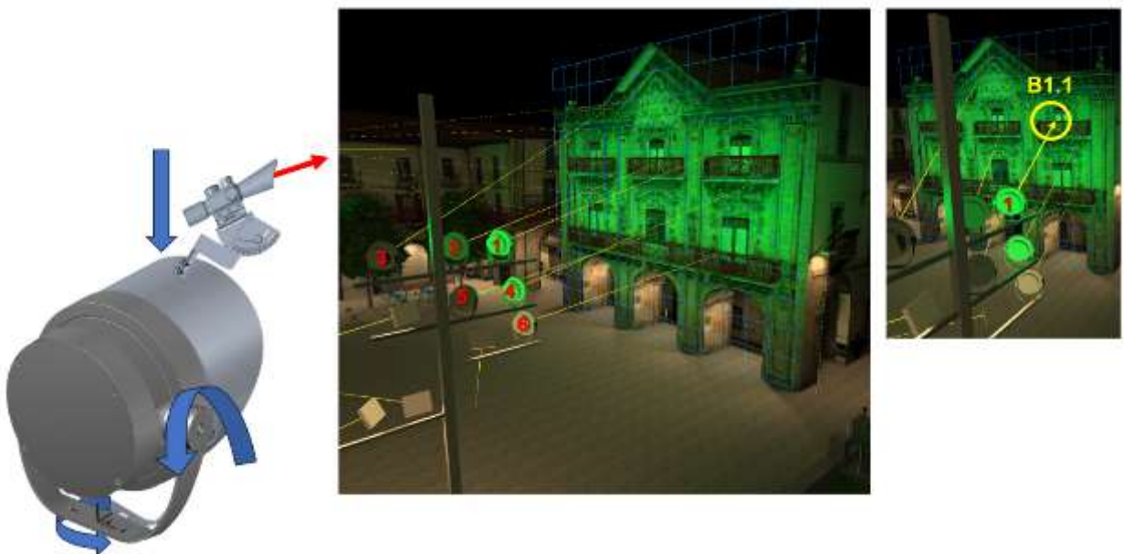
Foto del visor del proyector con puntero laser y sistema de apuntamiento
