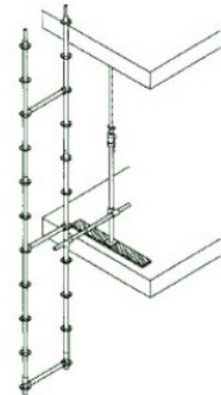
Amarre con puntal metálico
