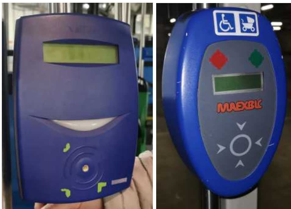
Figura 4: Validadora delantera (Valtick) y Validadora Central (Maexbic COM3).
