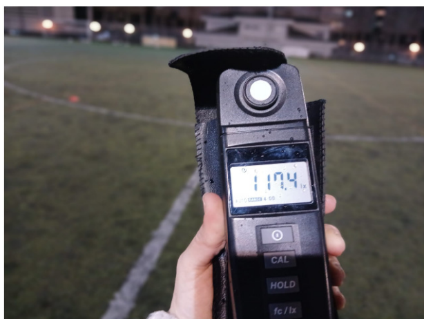
Figura 7: Detalle de medición desde el lateral en la zona central del campo: 117,4 luxes
