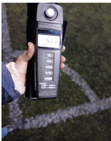
Figura 6: Detalle medición zona corner: 52,1 luxes
