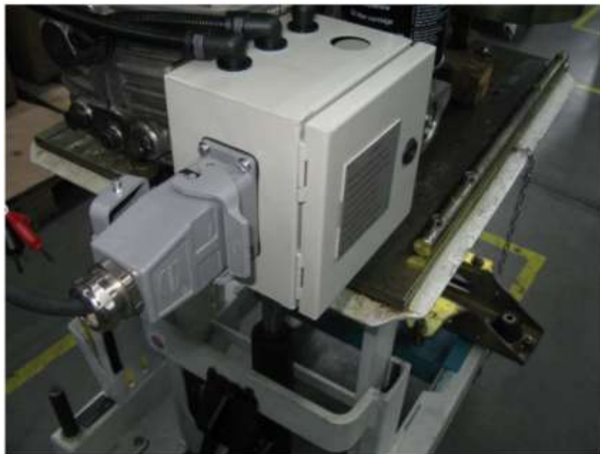
Foto 2. Conector harting para monitorización de señales eléctricas.
