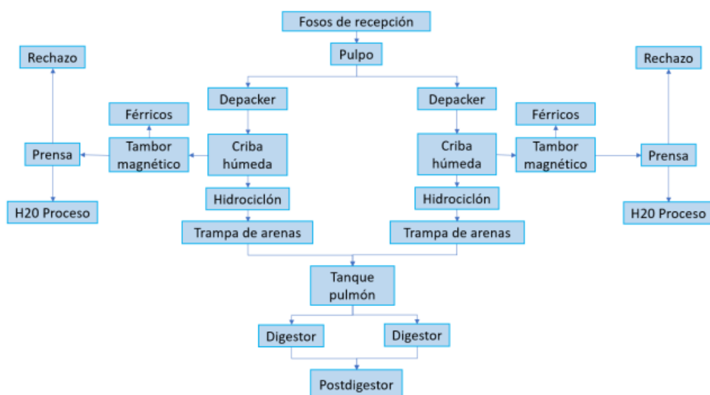
Ilustración 3. Diagrama de proceso pretratamiento y digestión
