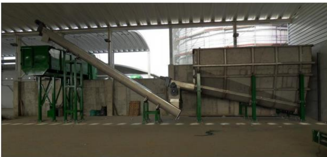
Ilustración 6. Ejemplo de implantación sistema tolva-tornillo
