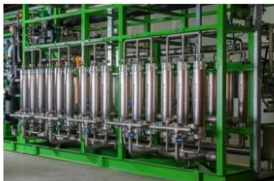
Ilustración 34. Sistema de upgrading mediante membranas
