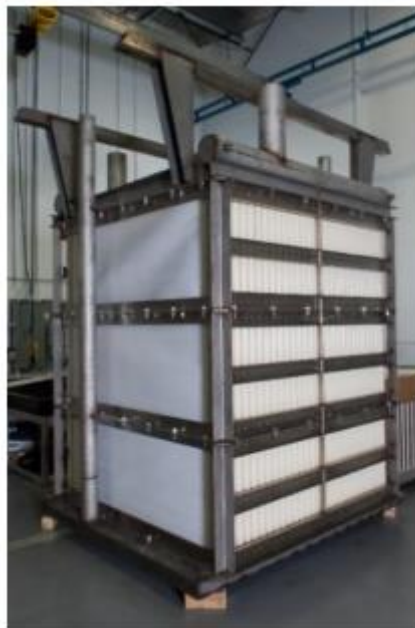
Ilustración 24. Módulo de ultrafiltración
