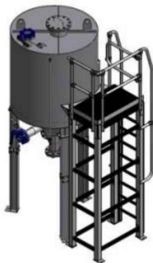
Ilustración 32. Representación 3D tanque carbón activo
