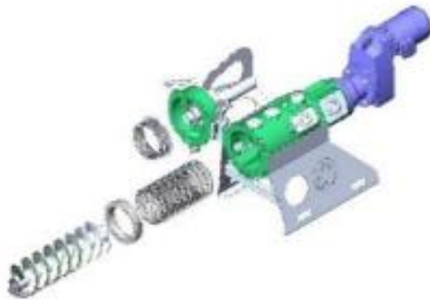
Ilustración 20. Diagrama de componentes de un filtro prensa
