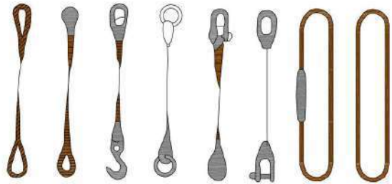
ESQUEMAS DE LOS DIVERSOS TIPOS DE ESLINGAS
